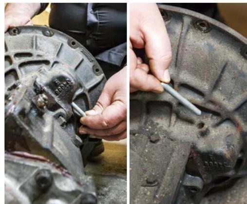
Ein bundloser Splint hält den Ausdrücker der Kupplung im Getriebegehäuse. Fällt er heraus, kann nicht gekuppelt werden.
