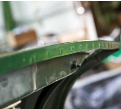
An den Kotflügeln oder am hinteren Kofferraum sollten Schweisspunkte zu sehen sein. Wenn nicht, wurde unsachgemäss repariert.
