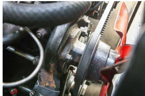
Vertrauenserweckend: ein aufgeräumter Motorraum (o.). Haben die Gestänge viel Spiel, ziehen die Vergaser Fremdluft und liefern zu mageres Gemisch. Folge: Motorüberhitzung (M.). Zu straffe Keilriemen zerstören die Lager von Wasserpumpe und Lichtmaschine (u.).
